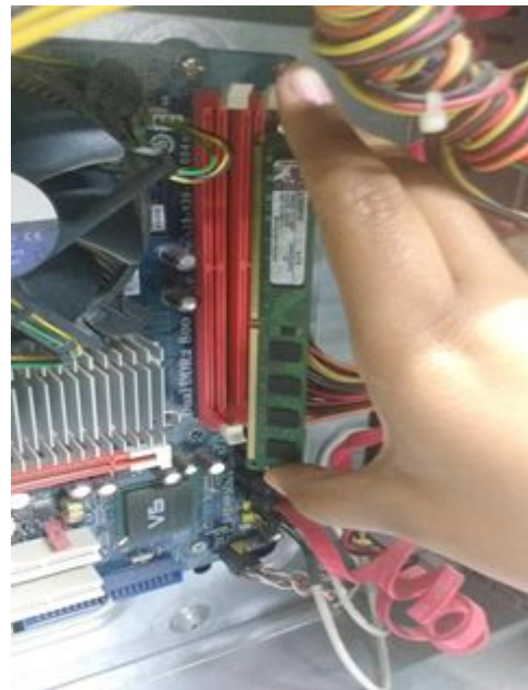
Figura 6: Encaixe de memória RAM no slot (Fonte: autor)
