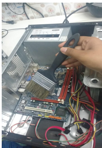
Figura 8: Remoção de resíduos utilizando pincel (Fonte: autor)
