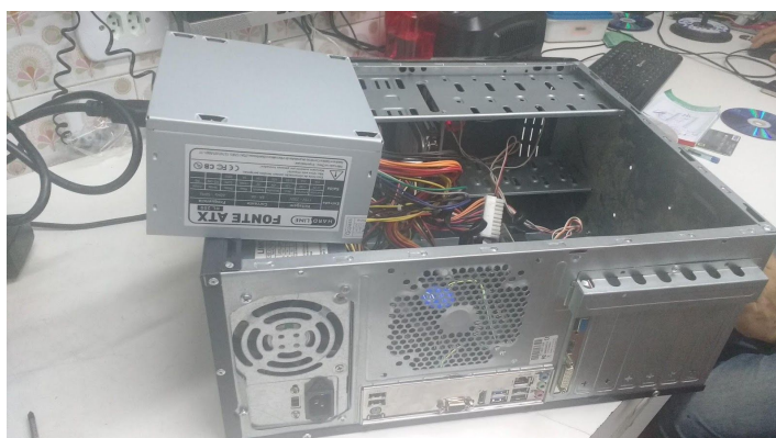
Figura 21: Conexão de nova fonte na placa mãe (Fonte: autor)
