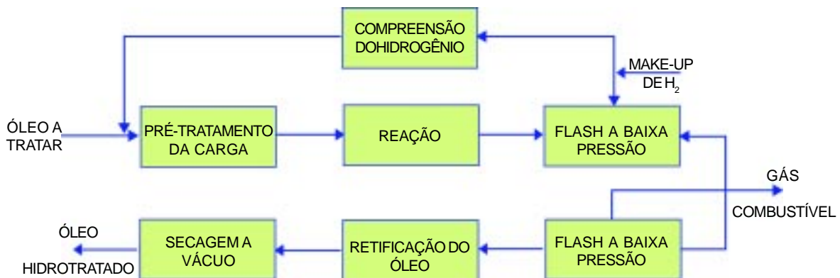
Diagrama esquemático do hidrotratamento de lubrificantes.
