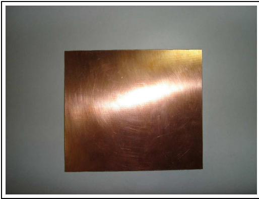
Figura 7.3: Placa de Fenolite ou Fibra virgem
